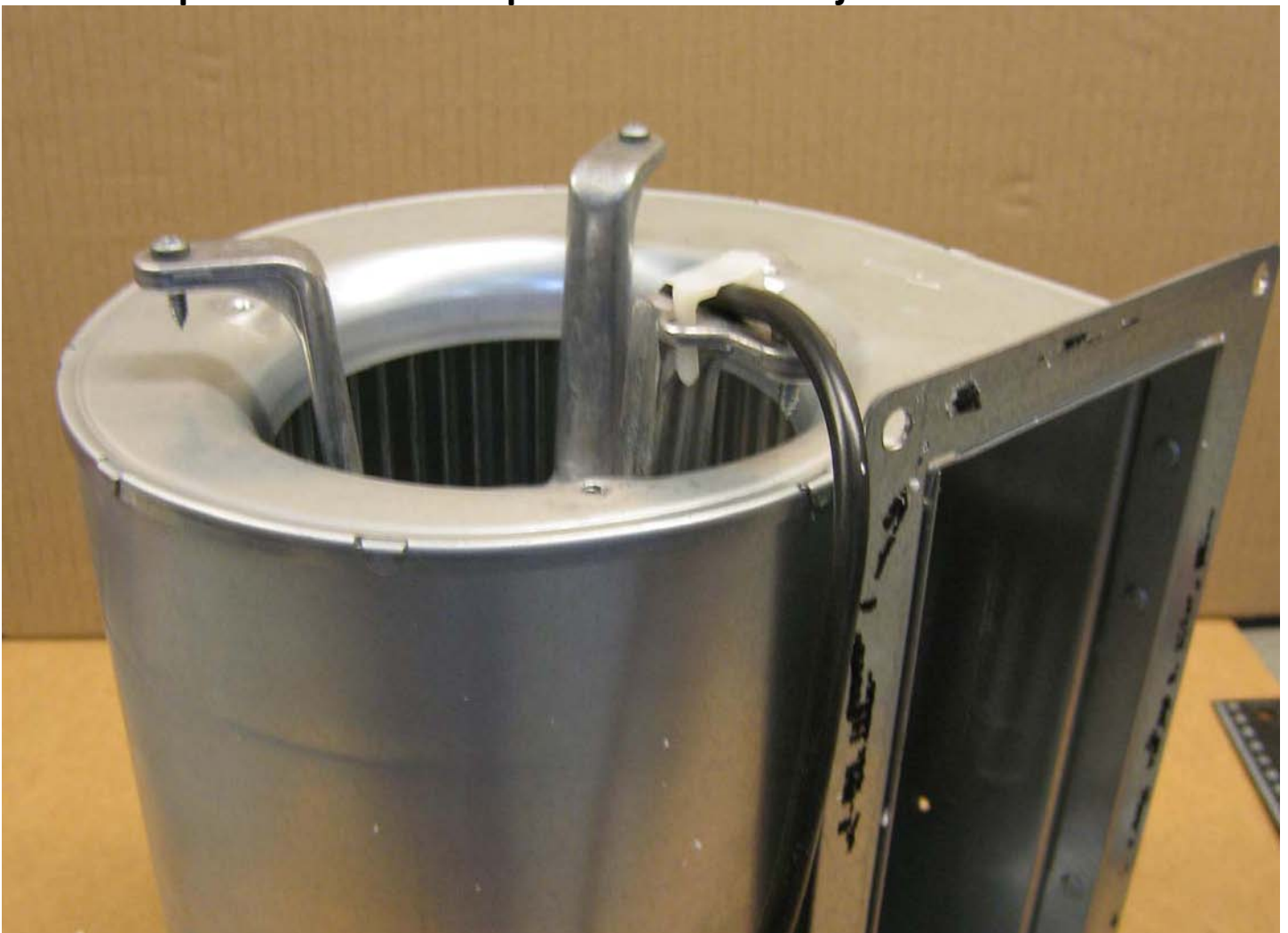
Moottorin kiinnitysjalat on irrotettu kaavusta ja kaapu laskettu alas. Moottori siipineen on kuitenkin tukevasti pöydällä.
