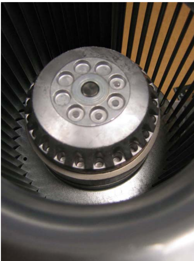
Kuva 68mm moottorin olakkeesta, jota vasten "jiki" asetetaan. S1
